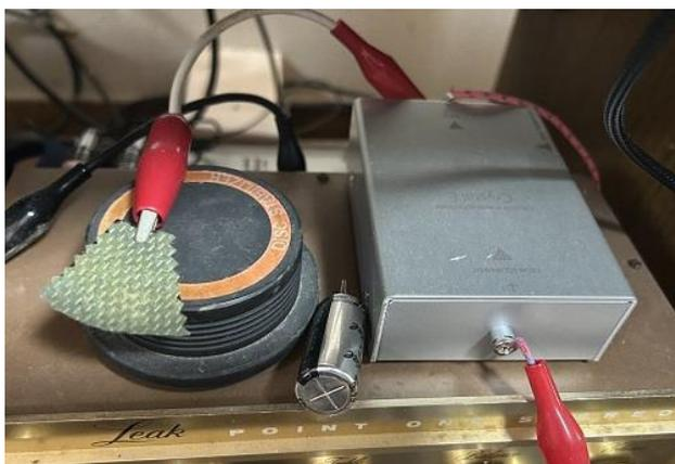
さらに Crystal E を外して、CD アンチスタティック単独あるいは CD アンチスタティックとコンデンサーを直接 Leak Point1 のアースポートに直接接続してみます。
