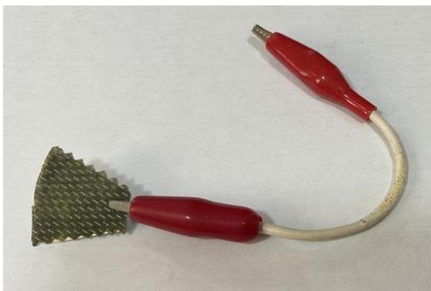
ステンレス板で補強して CD アンチスタティックを挟む。
