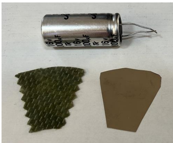
上：10000 \mu F コンデンサー 左下：CD アンチスタティック 右下：ステンレス板
