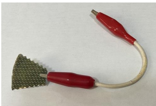
ステンレス板で補強して CD アンチスタティックを挟む。 さらにコンデンサーも追加する。
