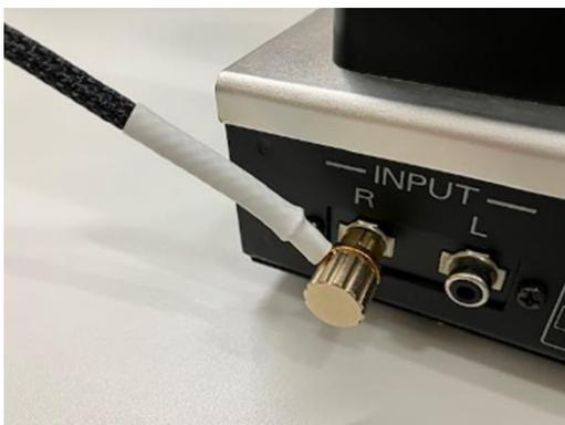
RCA キャップによる GND 端子化
