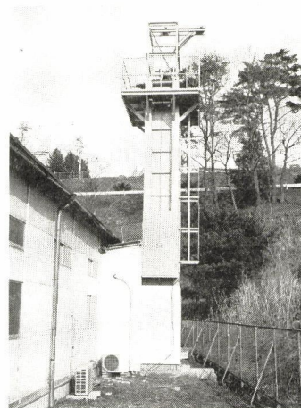
図6. ストリップ線路を用いた吸収体評価装置 (東北化工社殿のご好意による)
