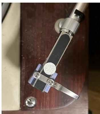
Garad401 と位置を入れかえることによりフォノケーブルの中継ケーブルを Vital Audio の2mから LINN のケーブルの 1.2m に替えて短縮します。
