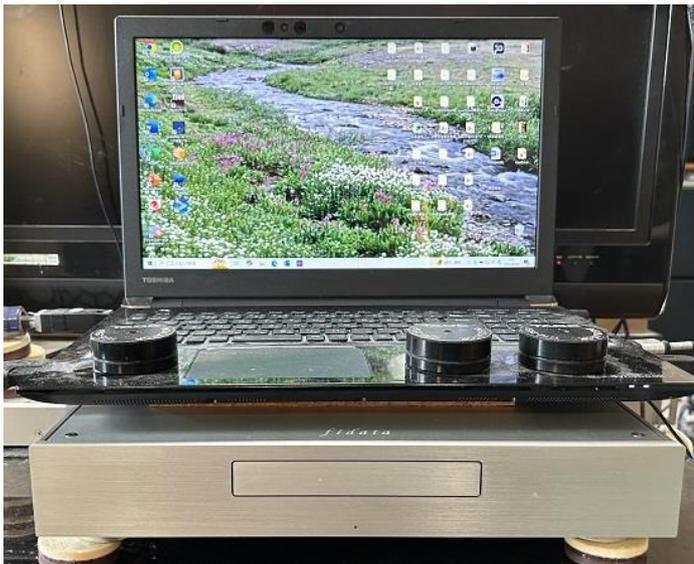
上記のように動作確認のため設置箇所を検討するとともに、シママセンでの経験を参考に、for Audio の USB 端子から USB2.0 ケーブル(USB リベラメンテ : USB アクイライザー介在)で DAC と接続、to Host の USB 端子から USB2.0 ケーブル(USB リベラメンテ : USB アクイライザー介在)で fidata HFAS1-S10 と接続、to Host の USB 端子から USB3.0 ケーブル(非オーディオグレード)で PC の USB 端子との接続を行いました。
