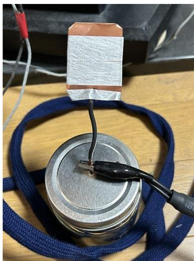
接続箇所は、まず、前報(15)と同じく FAL C90EXW の平面ユニットの方のスピーカー端子のマイナス側、次にハイルドライバーの方のスピーカー端子のマイナス側、さらにスピーカーアキュライザーの出力側の端子としてみます。この端子からは FAL C90EXW の平面ユニットとハイルドライバーへのバイワイアリング用スピーカーリベラメンテケーブル 2 本の 2 対が出ていますので、マイナス側端子に接続します。
