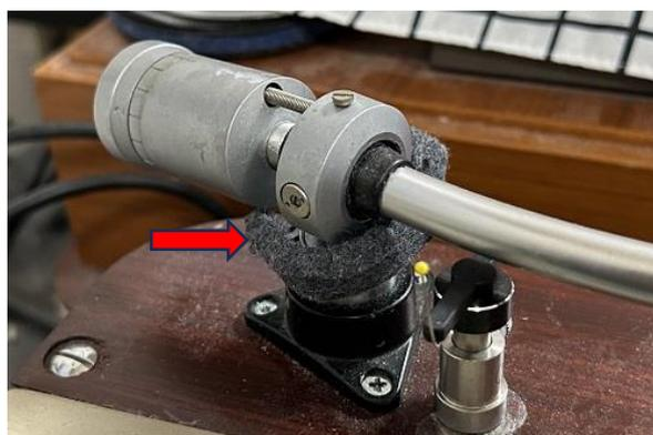
また、同様にポリエステルウールを使用したものも作成しました。ポリエステルウールは、建築用材料で、断熱材や防音材として使用されるものです。
