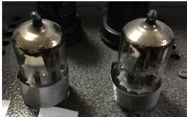
このことは、以前に実施した、次の写真のような銅のメッシュの真空管カバーに倣ったもので、飛び込みノイズの遮断、ガラスの帯電防止、マイクロフォニック振動のダンプなどを想定したものでした。今回は、飛び込みノイズの遮断を積極的に行わせるように考えました。
