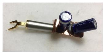
また、Crystal Ep 同士の連結に倣って、コンデンサーE のみを Crystal EpY の後部 に加えます。
