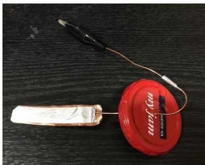
銅板に NRF-005T を貼り付け
