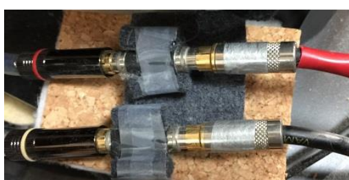
TruPhase への RCA 出力端子 NRF-005T を貼りつけ
