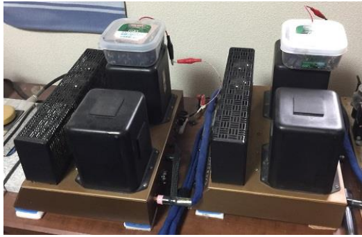
ミッドバス〜ツイーター駆動 45pp スピーカーケーブル出力端子 前報(20)仮想アース製作品
