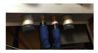
チャンネルデバイダーのレベルコントロールノブは、L/R 各 3 チャネル×2 計 6 個の 模造品 8 号を貼ります。
