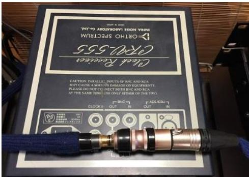
CD トランスポートからの RCA ディジタル出力を受けて、AES 出力に変換できる変換コネクターを経由させ、AES ケーブルで BrooklynDAC+ の AES 端子に入力します。
