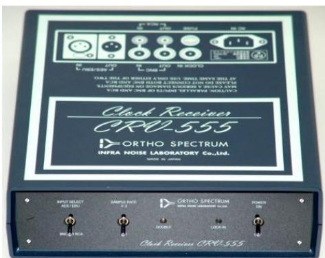
CRV-555 は RCA 入力と AES 出力がありますので CD トランスポートからの RCA デジタル出力を受けて AES 出力に変換できます。AES ケーブルで CRV-555 からの AES 出力を受け、Brooklyn DAC+の AES 端子に入力します。なお、CRV-555 はクロック入力がないと動作しませんので、GPS-777 から 44.1Hz のクロックを入力します。
