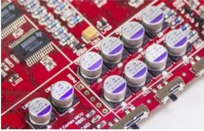
micro iDSD の電源部に搭載された OS-CON。可能な限り高品位なパーツを投入することで、S/N 感や空間表現力、質感表現力など音楽に関わる重要な要素を向上させた。また音質の良さで定評のある導電性高分子アルミ個体電解コンデンサー「OS-CON」をこのアナログステージ電源用に用いたほか、デジタル回路用電源、ヘッドホンアンプ用電源にも採用するなど、計 12 基もの大量投入を実現した。ほかにもパナソニック製の面実装フィルムコンデンサー、KEMET 製タンタルコンデンサーを新たに採用。さらにはメルフ抵抗など、こだわりのパーツを要所ごとに取り入れ、サウンド面も大きく進化した。」
