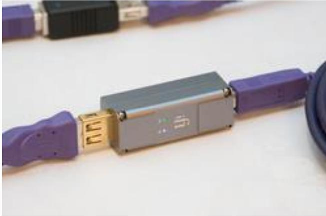
「iPurifier2 type A」は、「iPurifier2 type B」に続いて登場した USB オーディオアクセサリの第二世代モデル。本機は出力側の端子に USB-A を採用。独自のアクティブ・ノイズキャンセリング (ANC) および REclock/REgenerate/REbalance 技術を採用。USB 信号の伝送におけるジッターおよびノイズの排除を徹底した。」
