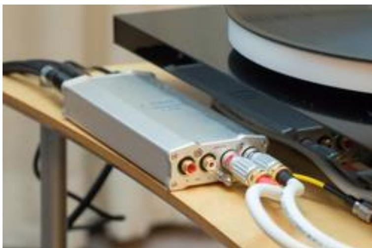
「micro iPhono2 は、現行製品の「micro iPhono」の後継となるフォノアンプ。機能は従来モデルを引き継ぎつつ、J-FET チップを ESS 製からバー・ブラウン製に変更。また、カートリッジに合わせたゲインの変更幅を、従来の 66dB までから 72dB までへと強化した。回路設計も大幅に変更。サーボに加えて、従来モデルでは採用していたカップリングコンデンサーも排除することで音質を大幅に高めた。結果、S/N は従来機の 82dB から 85dB へ、ダイナミックレンジは 90dB から 106dB へ改善されたという。」
