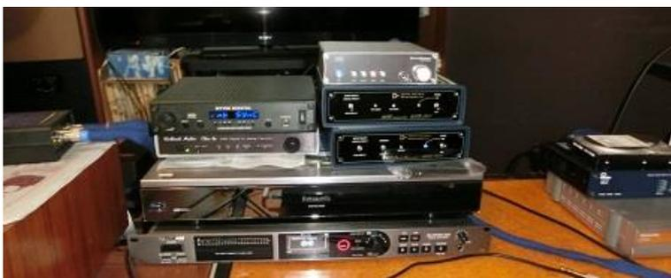
次に SWD-DA10 のアナログ出力を DA-3000 に入れ、DA-3000 で DSF,5.6MHz の設定にして INPUT MONITOR の状態で SDIF-3/SDIF-raw の伝送により MYTEK
